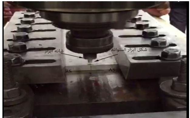
شکل 1- تجهیزات مورد استفاده برای فرایند جوشکاری اصطکاکی اغتشاشی.
