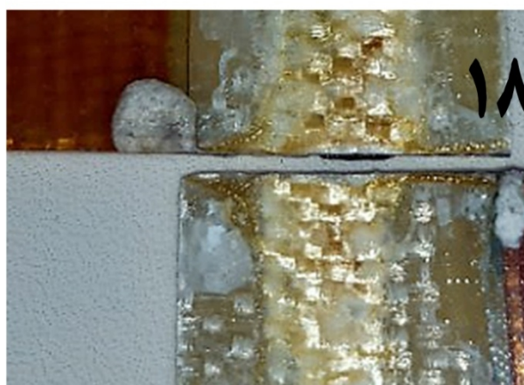
شکل 6- تصاویر نحوه شکست نمونه‌های 1 و 7 و 11 و 18
