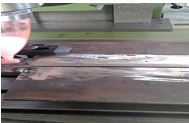
شکل 2- توزیع نانو مواد در طرح اتصال جوش
