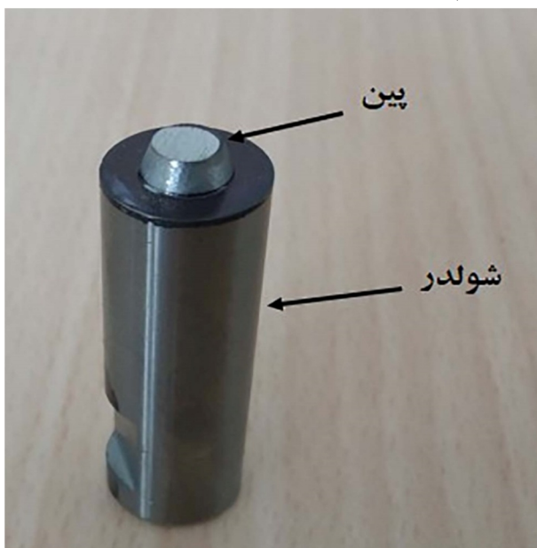
شکل 1- تصویر پین و شولدر جوشکاری اصطکاکی همزنی.
