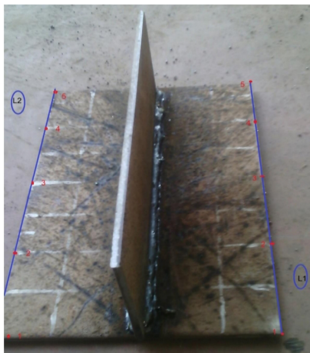
شکل 2- ورق بعد از انجام جوشکاری
