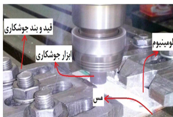
شکل ۱- تصویر فرایند جوشکاری اصطکاکی اغتشاشی
