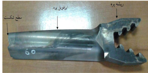
شکل 1- پره شکسته شده
