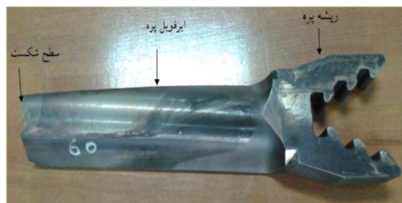
شکل ۱- پره شکسته شده
