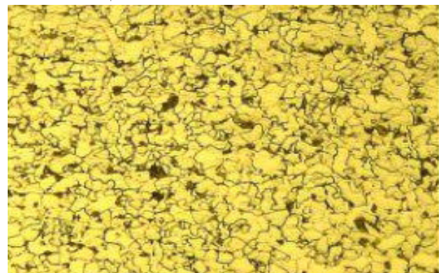
شکل ۱۶- تصاویر میکروسکوپی پاس پرکن
