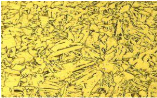
شکل ۱۷- تصاویر میکروسکوپی پاس سطح
