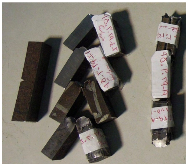
شکل ۱۹- سطح مقطع شکست نمونه‌های آزمون ضربه
