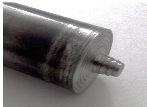
شکل ۲- ابزار طراحی شده جهت جوشکاری اصطکاکی اغتشاشی
