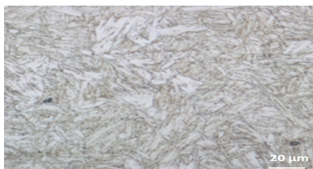
شکل ۲- ریزساختار فولاد مقاوم به سایش.
