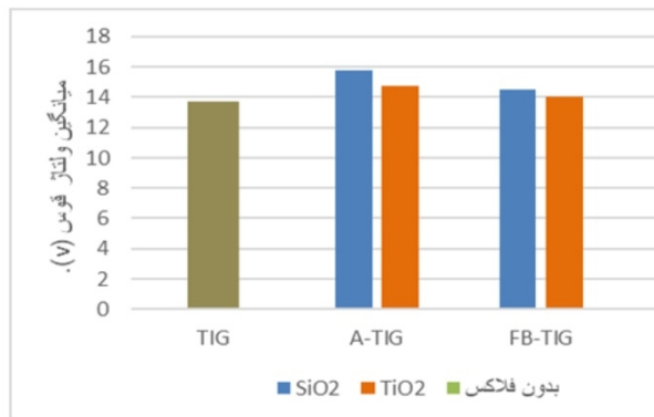
شکل ۵- میانگین ولتاژ قوس برای روشهای A-TIG و FB-TIG در حضور دو فلاکس \text{SiO}_2 و \text{TiO}_2
