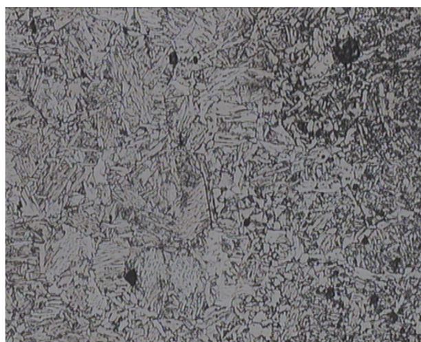
شکل 8 - ریزساختار میکروسکوپ نوری منطقه‌ی متاثر از حرارت واقع در لوله‌ی اصلی
