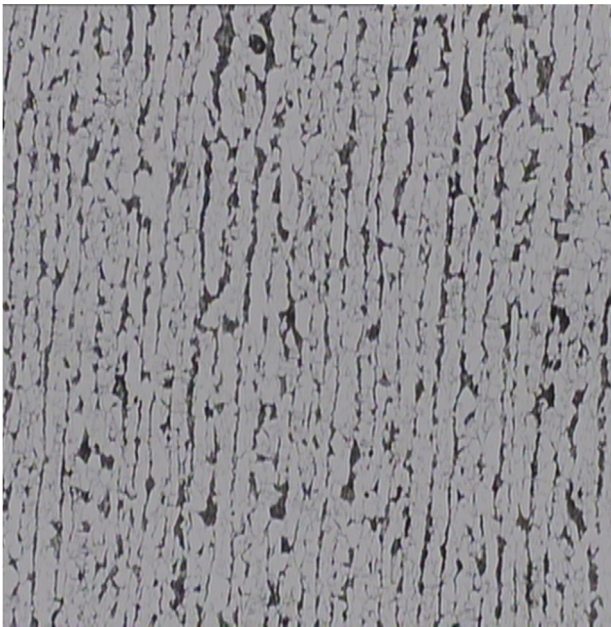
شکل 4- ریزساختار میکروسکوپ نوری فلز پایه (فولاد لوله) که شامل لایه های فریت و پریت است
